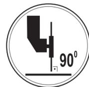
Estes discos devem trabalhar apenas com a superfície periférica (topo) perpendicular ao eixo da peça. São fabricados em liga orgânica, com ou sem tela de reforço, dependendo da aplicação e velocidade periférica de trabalho a que se destinam. A lateral do disco de corte não deve ser utilizada em hipótese alguma, como, por exemplo: rebarbações diversas, afiação de ferramentas etc.
