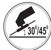
Discos fabricados em liga orgânica, com telas de reforço. São providos de depressão na parte central, para que o flange de fixação não prejudique o trabalho. Estes discos devem trabalhar tipicamente com superfície periférica e também na superfície lateral, desde que a inclinação da ferramenta em relação à superfície de trabalho seja mantida entre 30° e 45°.
